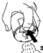
**3.** Pulvériser tête en bas en pressant le bouton. A la fin de l'opération, purger l'aérosol quelques secondes vers le haut. L'aérosol doit être positionné à environ 15 cm de la surface à marquer.
