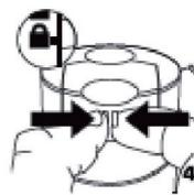
**4.** Re-verrouiller le capot en dépliant les ergots pour permettre le retour du bouton poussoir.
